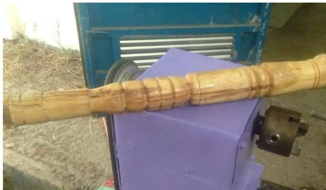
Gambar 16. Percobaan kaki meja diameter 60 mm panjang 400 mm
