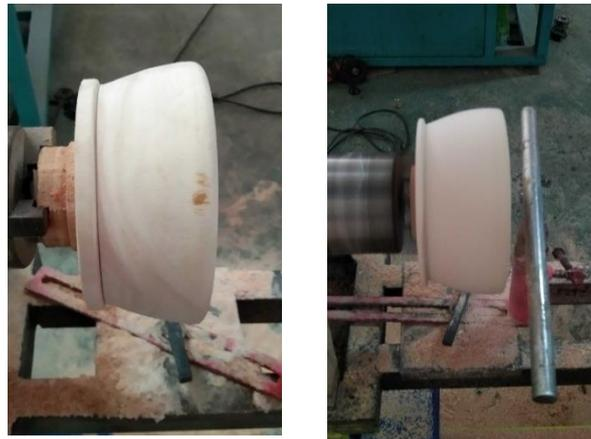
Gambar 12. Proses membubut permukaan benda kerja
