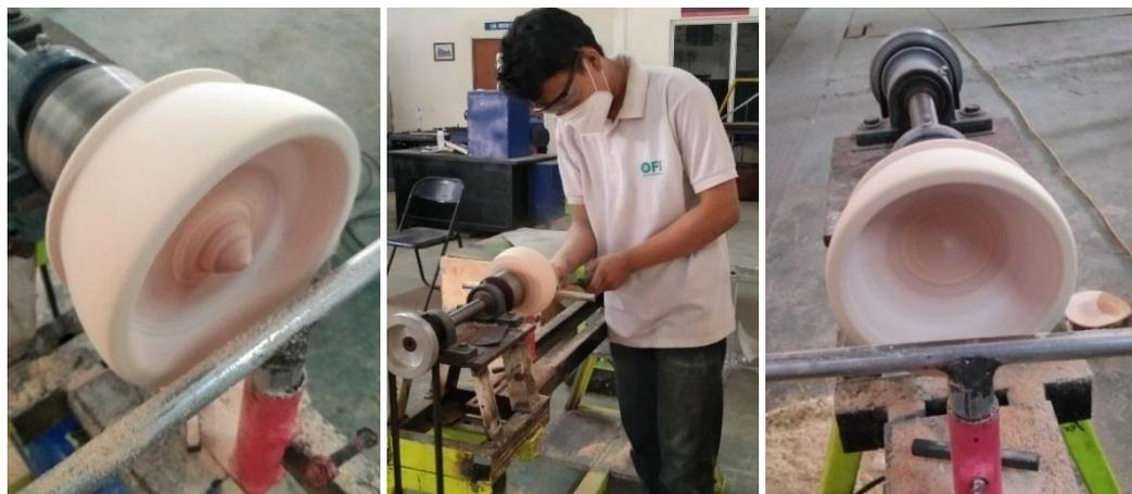
Gambar 13. proses membubut permukaan dalam benda kerja
