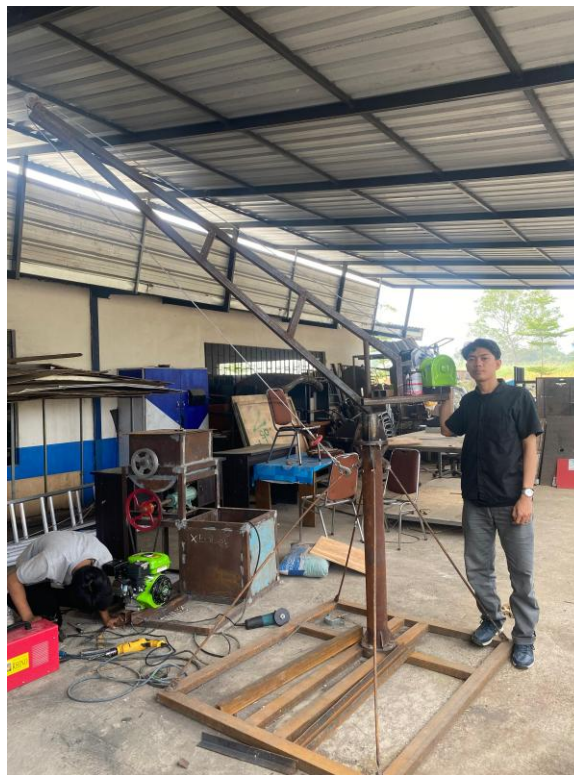
Gambar 3. Hasil Perakitan mini crane
