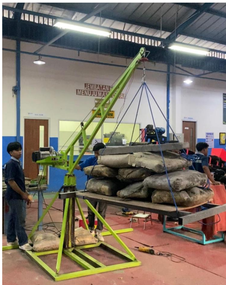
Gambar 4. Uji angkat beban
