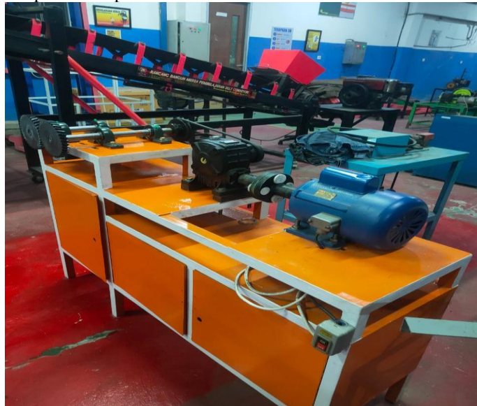
Gambar 6. Hasil Pengembangan Modul Pembelajaran Alignment Roda Gigi Spiral
