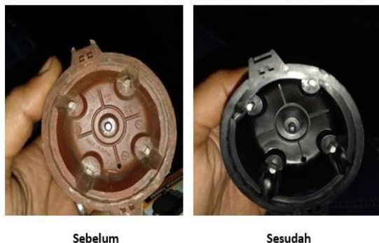
Gambar 4. Penggantian Tutup Delco (Sumber: Penulis, 2025)
