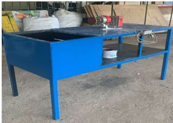
Gambar 4 Rancang Bangun Mesin Pembersih Stiker Gelas Plastik LDPE
