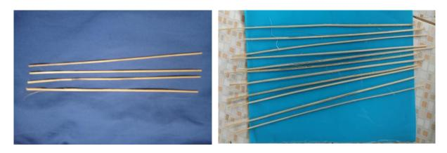
Gambar 12. Hasil penyerutan bambu panjang 40cm
