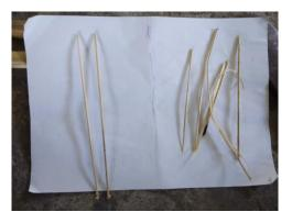
Gambar 9. Hasil penyerutan bambu (panjang 20 cm, lebar 6 mm)
