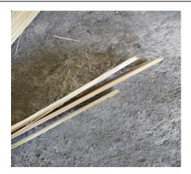
Gambar 5. Hasil pengiratan bambu dengan panjang 20 cm yang layak pakai
