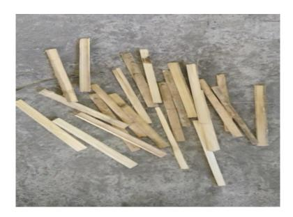
Gambar 4. Hasil pengiratan bambu dengan panjang 20 cm yang tidak layak pakai
