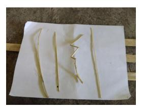
Gambar 8. Hasil penyerutan bambu (panjang 20, cm lebar 3 mm)
