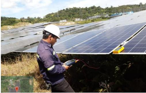
Gambar 3 Proses pengukuran Kurva I-V
