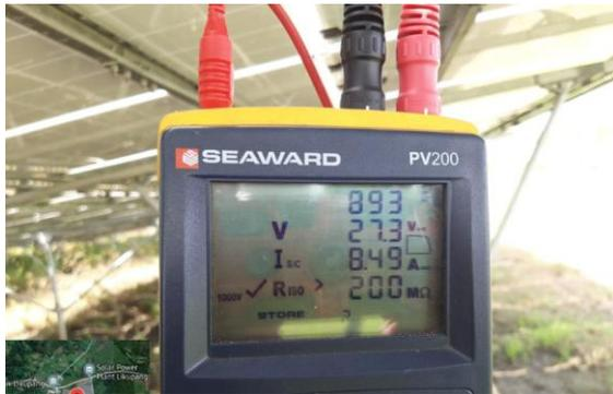
Gambar 4 Hasil pengukuran dan proses seleksi Kurva I-V
