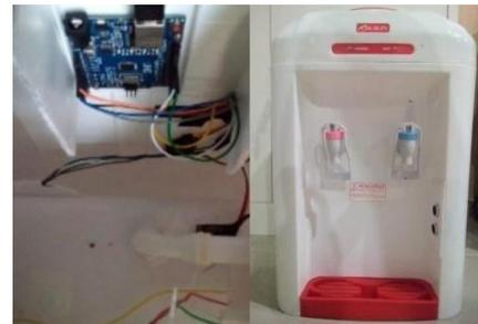
Gambar 6. Hasil rangkaian dispenser otomatis.
